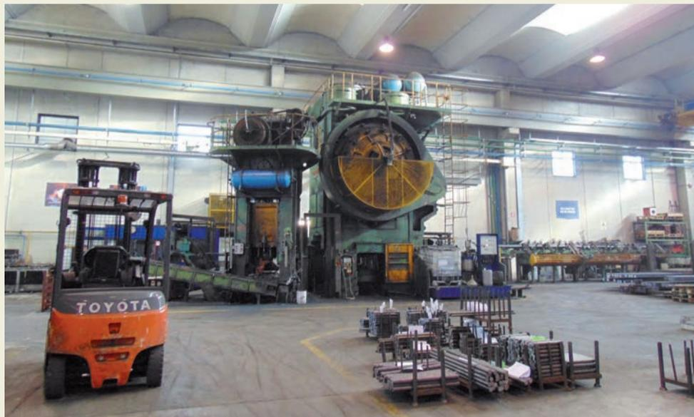
► Paolo Cantamessa: "continuiamo a offrire mozzi in acciaio realizzati a Carpenedolo (nella foto la forgia da 4.000 tonnellate), mentre altri competitors sono passati ai mozzi in ghisa prodotti nel Far East. Si tratta di un importante elemento di differenziazione, in un mercato che è piuttosto omologato"
